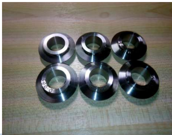
РОЛИКИ ДЛЯ НАКАТКИ РЕЗЬБЫ НА ТРУБАХ УБТ (ИЗГОТОВЛЕНИЕ РОЛИКОВ НАКАТКИ)
