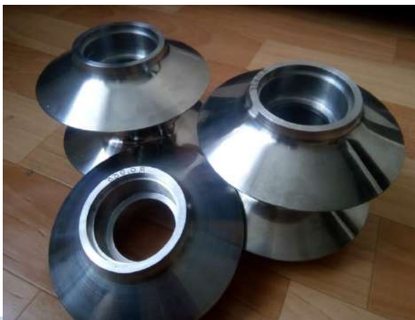
РОЛИКИ ДЛЯ НАКАТКИ РЕЗЬБЫ НА ТРУБАХ УБТ (ИЗГОТОВЛЕНИЕ РОЛИКОВ НАКАТКИ)
